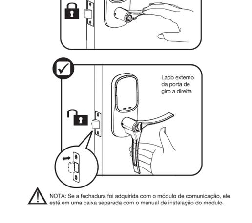
Se o teste de operação da trava interna falhar, verifique a instalação começando no Passo 3.
