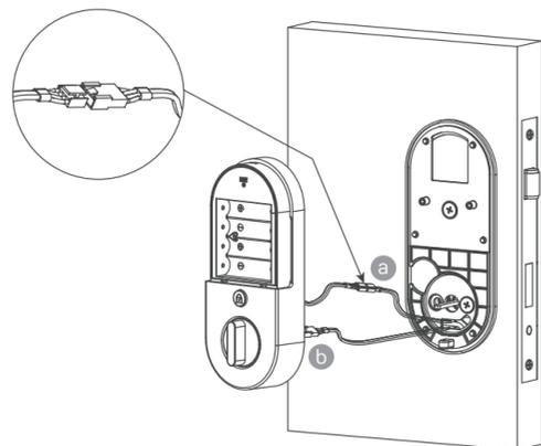
**a** Faça a conexão do chicote da máquina no chicote do painel interno
