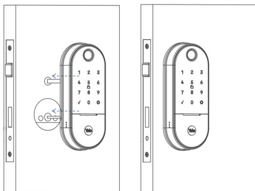
Passe os chicotes da máquina e do painel externo para o lado interno da porta e posicione o painel externo na superfície da porta
