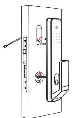
Passa os chicotes da máquina e do painel externo para o lado interno da porta e posicione o painel externo na superfície da porta
