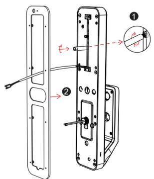
Encaixe a moldura e a caixa de parafuso no painel externo da fechadura
