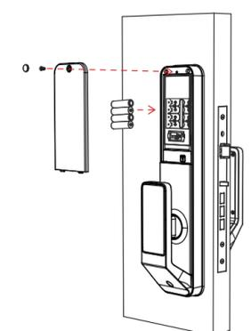
Coloque 4 pilhas AA e encaixe a tampa do painel novamente
