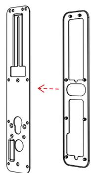
Coloque a borracha na chapa de fixação, passe os fios e parafuse-a na porta, conforme indicado.
