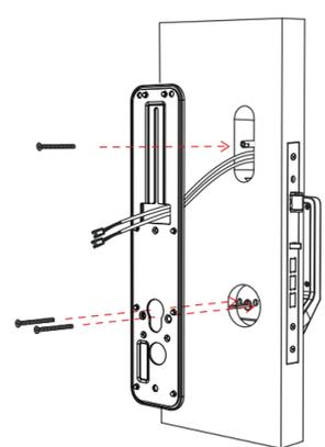
Faça a conexão do chicote da máquina no chicote do painel interno. Conecte o chicote do painel externo no painel interno
