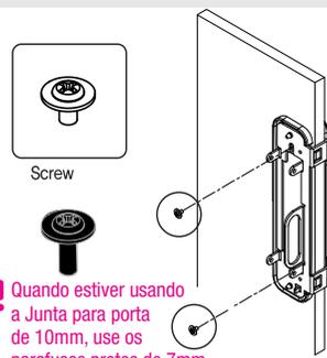
! Quando estiver usando a Junta para porta de 10mm, use os parafusos pretos de 7mm.
