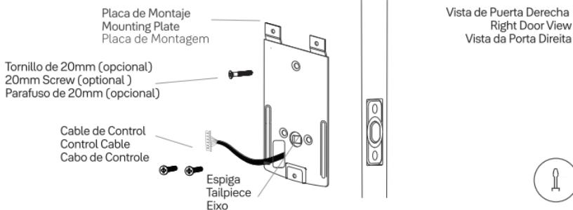
**B. Coloca la placa de montaje contra la puerta con la espiga pasando de forma vertical por el orificio central de la placa.** / Place the mounting plate against the door with the tailpiece passing vertically through the center hole of the plate. / Coloque a placa de montagem contra a porta com o eixo passando pelo furo central da placa de montagem.
