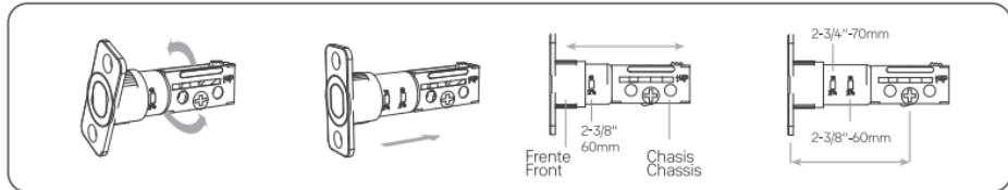
**Para ajustar el backset de 60mm a 70mm jala y gira el chasis en sentido de las manecillas del reloj como se ilustra en la figura.** / To convert the backset, pull and rotate the chassis clockwise as illustrated in the figure. / Para converter o backset de 60 mm para 70 mm, puxe e gire o chassi no sentido horário, conforme ilustrado na figura.
