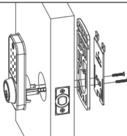
**A. Desempaca el cuerpo exterior. Ten cuidado de no rayar la placa de circuito durante la manipulación e instalación.** / Unpack the exterior escutcheon. Be careful not to scratch the circuit board during handling and installation. / Desembale o corpo externo. Cuidado para não arranhar a placa de circuito durante o manuseio e a instalação.
